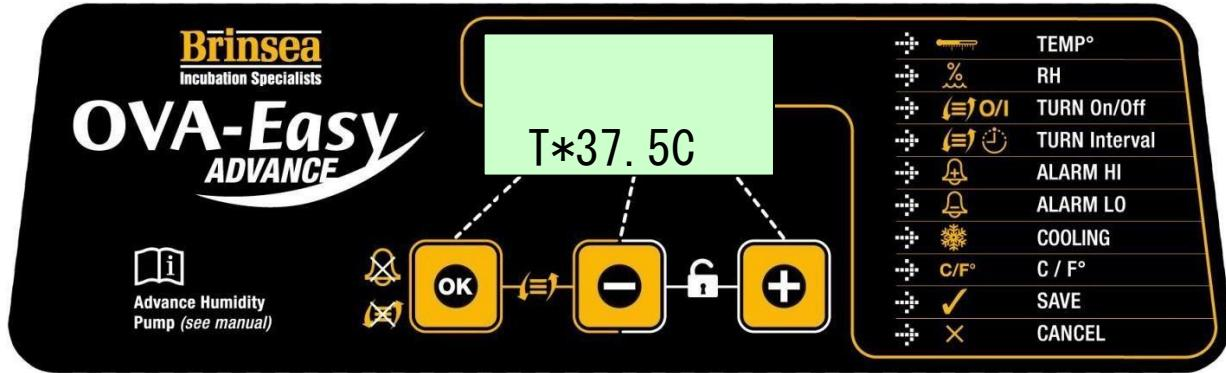
Система управления инкубатора Ova-Easy Advance использует высокоточные датчики температуры и влажности, подверженные индивидуальной калибровке. Будьте осторожны, используя дешевые аналоговые или цифровые термометры и гигрометры, при сравнении их показаний с показаниями дисплея инкубатора.
